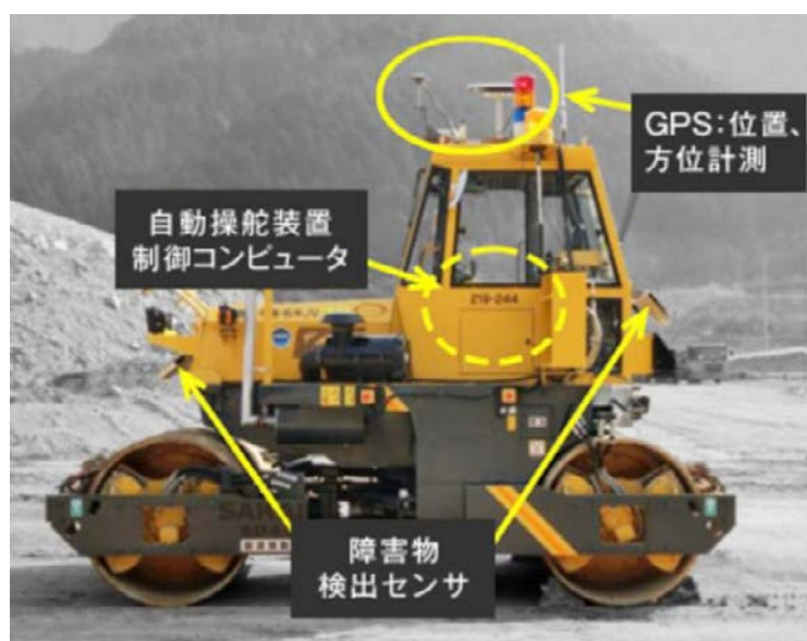
自動化装備した振動ローラ
