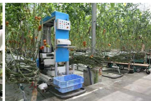
トマトを自動で収穫するロボット
