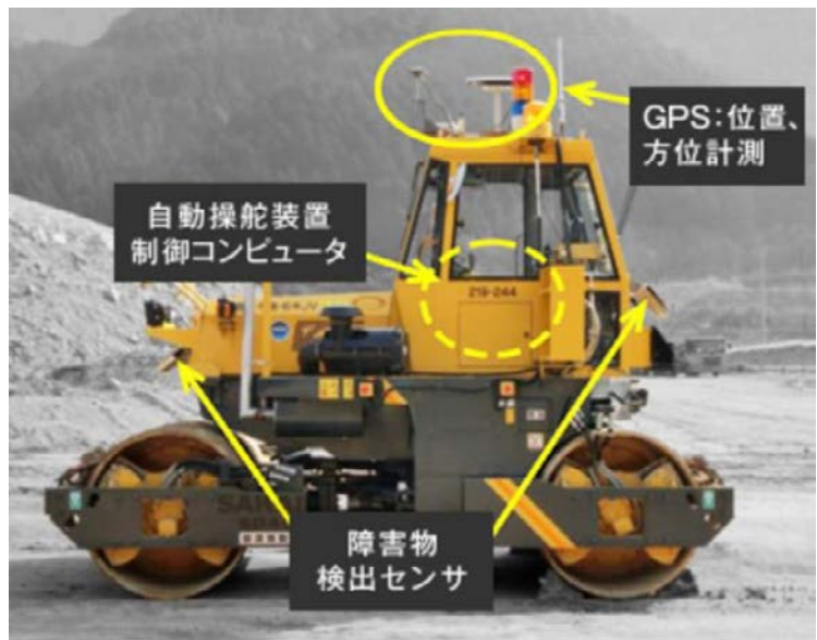
自動化装備した振動ローラ
