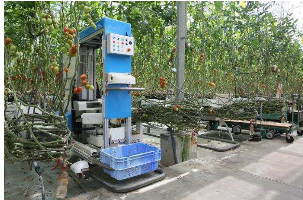
トマトを自動で収穫するロボット
