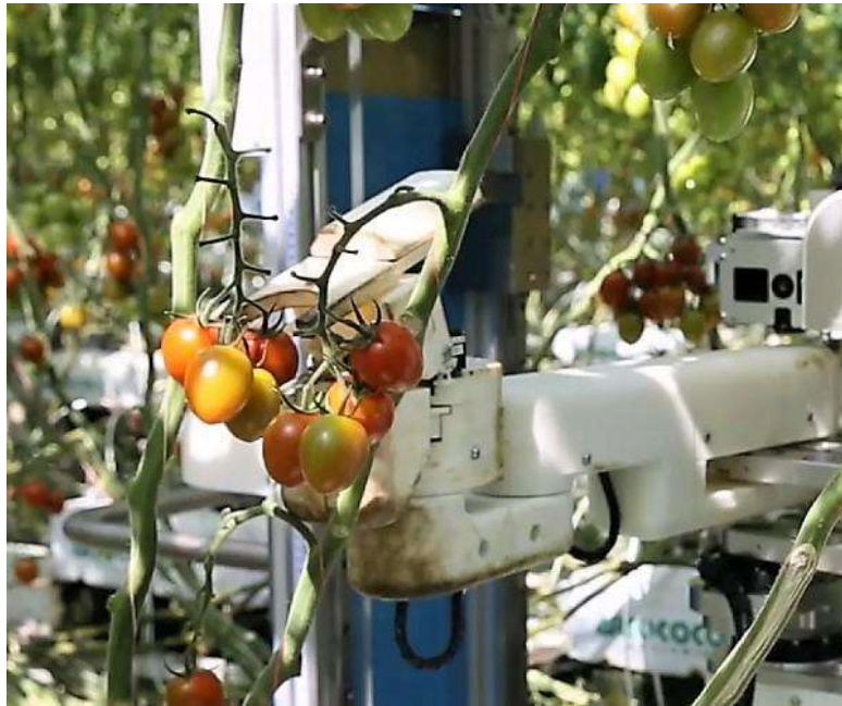
収穫ロボットが実際にトマトを収穫する様子
